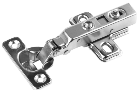
Петля мебельная с доводчиком для накладной двери Clip-on Boyard / H404A21/2210 / 95° / чашка.26мм
